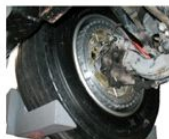
図5 フロントアサルト部の写真 Fig.5 Front axle with in-wheel motor
