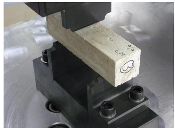
図 2 PCM の曲げ強度試験
